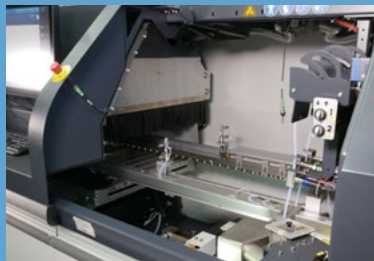
Flexibel integrierbares Lötssystem: Inline- oder Batchbetrieb
