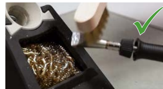
Alternative Methode: Reinigung mit Messingbürste (3ZT00051)
