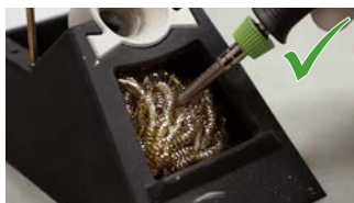
Lötspitze leicht in die Metallwolle einstecken und drehen.
