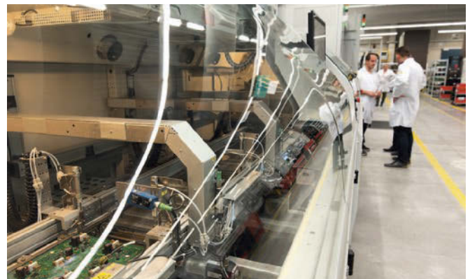
Freie Sicht auf den Lötprozess: Die Multiwellen-Selektivlötanlage Versaflow 3/45 erlaubt den Blick ins Innere.
