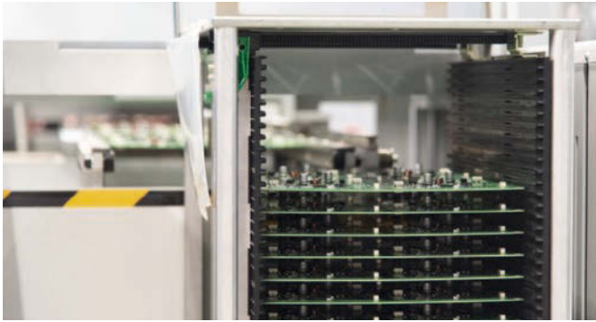
Magazine mit bestückten Leiterplatten sorgen in der elektronischen Baugruppenfertigung von Wilo für einen reibungslosen Ablauf und unterstützen die Inline-Fähigkeit der Multiwellen-Selektivlötanlage Versaflow 3/45.
