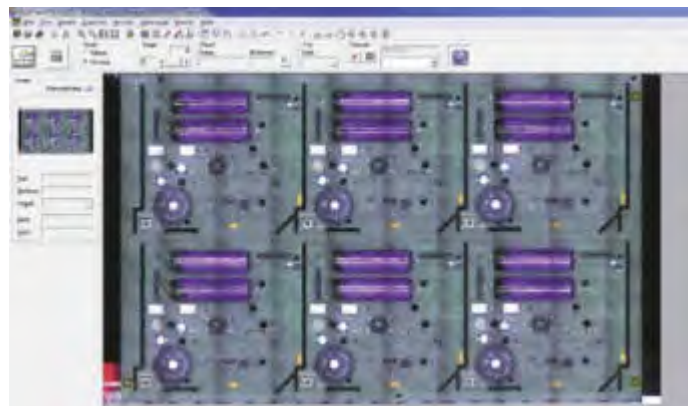
Integritätskontrolle vor dem Lötprozess mit VERSASCAN
