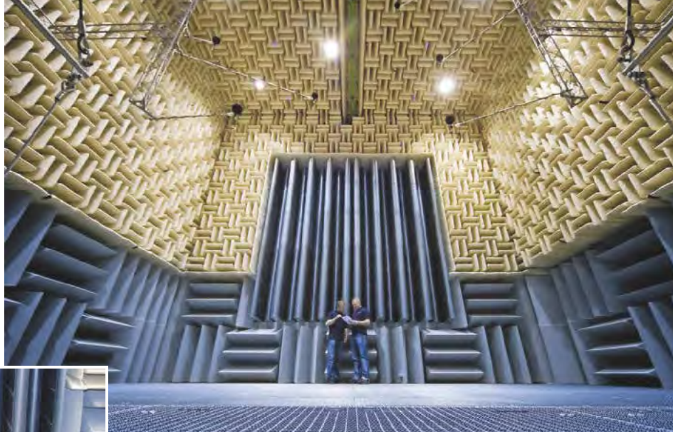
Geschäftspartner Ziehl-Abegg und Ersä im 1.250 t schweren Luft- und Geräuschprüfstand, in dem sonst Volumenströme mit bis zu 100.000 m 3 Luft pro Stunde und Drücke von über 3.000 Pascal gemessen werden können.
