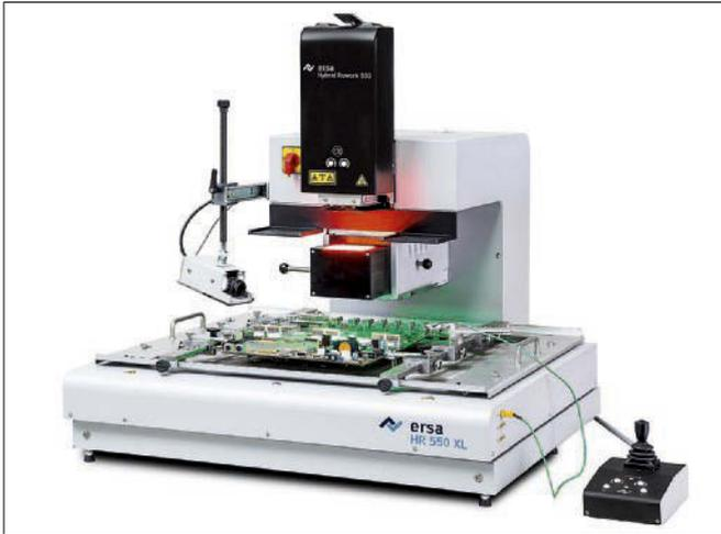
Leistungsstark und präzise: Der Halbautomat HR 550 XL weist acht Unterstrahler-Heizzonen auf. Die motorische X/Y-Feinverstellung und Bauteilrotation überzeugen ebenfalls.
