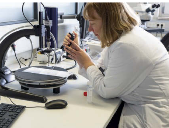
Aufbringen von Lösungsmitteltropfen auf eine Probe im Analyselabor von Zollner, um anschließend mit dem Ersascope 2 Bilder der Lösungsmitteltropfen aufzunehmen.
