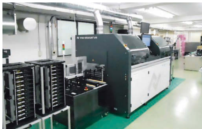
Die Pulax-Elektronikfertigung mit einer der beiden Ersa-Selektivlötanlagen.
