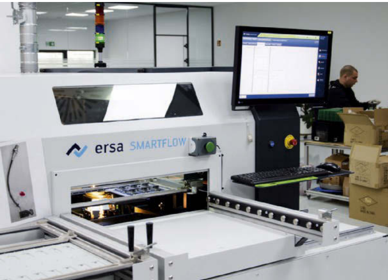
Seit August 2018 ist die kompakte Selektivlötanlage Smartflow 2020 von Ersa in der VTS-Elektronikfertigung im niedersächsischen Fürstenau in Betrieb.
