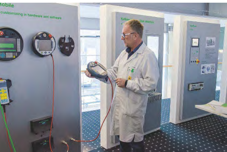
Erwin Schöfer, Werksleiter Elektronikfertigung & Produktmontage bei KEBA, mit einem Handterminal zum Teachen von Robotern.
