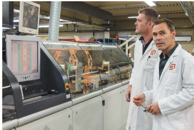
Die auf High Mix/Low Volume ausgelegte Fertigung macht den Dauereinsatz der zwei Selektivlötanlagen Versaflow 3/45 von Ersä erforderlich. Die positiven Erfahrungen mit Ersä machten die Drucker-Entscheidung leicht.
