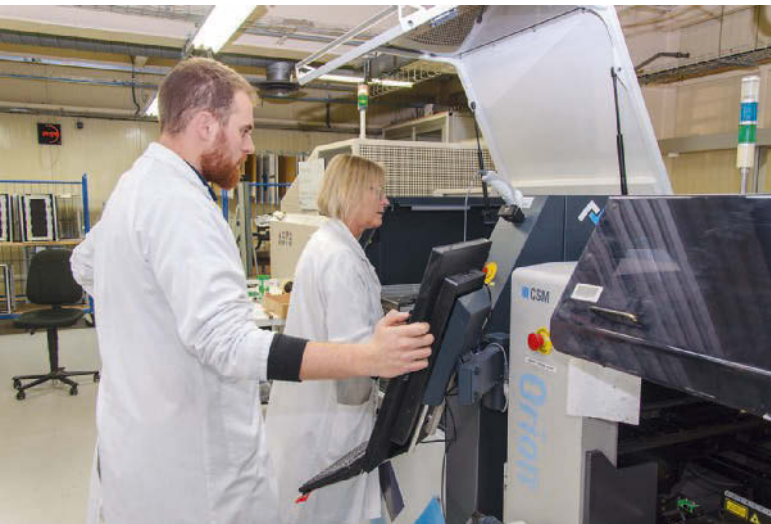
Eiffage-Mitarbeiter beim Einrichten des Schablonendruckers Versaprint 2. Im Benchmarking überzeugte der Schablonendrucker mit integrierter 100-Prozent-Inspektion in 3D auch durch die leichte Bedienbarkeit.
