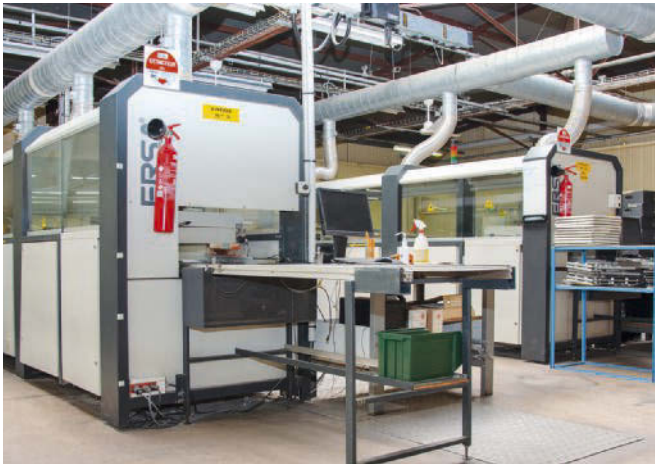
Die zwei Wellenlötanlagen von Ersa in der Eiffage-Elektronikproduktion zeugen von der langjährigen und engen Zusammenarbeit zwischen Systemlieferant und Kunde.
