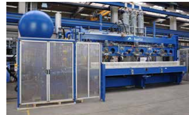
Kurtz Vertikalmaschine K761 V für EPS-Rollladenkästen
