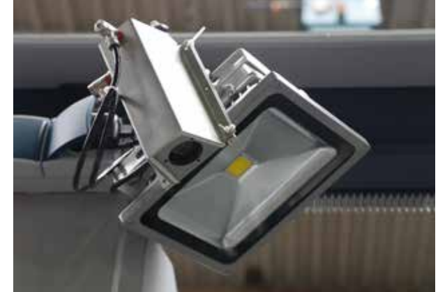
Kurtz Eject Control 4.0 – optische Entformungskontrolle
