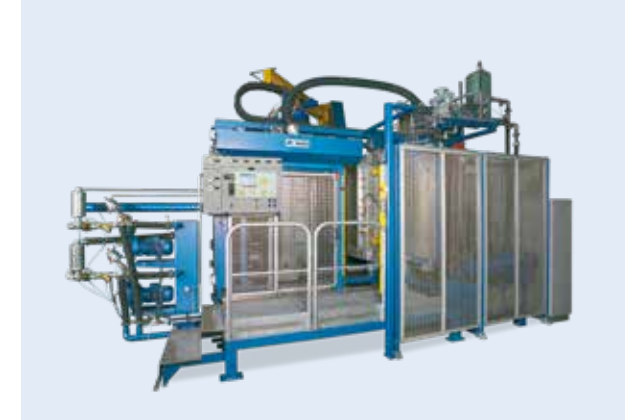
Anlage zur Herstellung von ICF-Elementen
