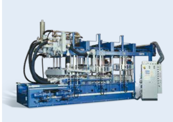
Formteilautomat mit Transfer-Technologie (3 Stationen)
