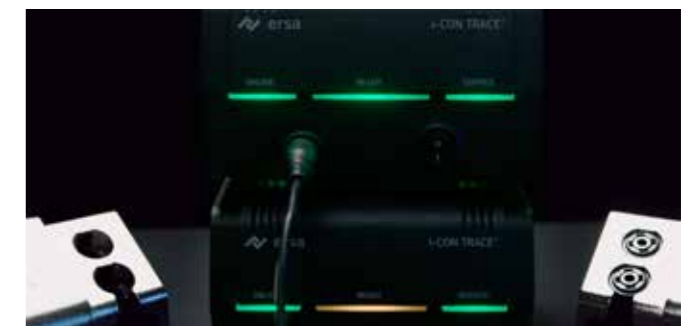
Einzigartiges Bedienkonzept: GREEN MEANS GO. Wenn alle Bedingungen für die zugeteilte Lötaufgabe erfüllt sind, gibt das LED-Interface der i-CON TRACE buchstäblich grünes Licht und der User kann mit dem Lötvorgang starten.
