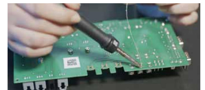
Prozessdaten-Dokumentation – die Connectivity der i-CON TRACE erlaubt es, jeden einzelnen Lötvorgang zu dokumentieren: Baugruppe, verwendete Spitze, Temperatur und Löttdauer werden elektronisch erfasst und können nachverfolgt werden. Links im Bild: Einscannen des QR-Codes der Lötspitze mit dem Hand-Scanner vor dem Löten.
