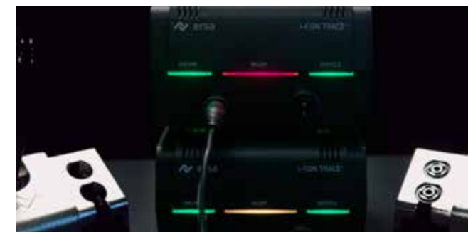
Einzigartiges Bedienkonzept: GREEN MEANS GO. Wenn alle Bedingungen für die zugeteilte Lötaufgabe erfüllt sind, gibt das LED-Interface der i-CON TRACE buchstäblich grünes Licht und der User kann mit dem Lötvorgang starten.
