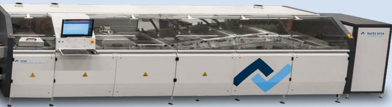
THT-Bauteile sind auch in der SMT-dominierten Elektronikfertigung nach wie vor fester Bestandteil technisch anspruchsvoller Flachbaugruppen für die Industrie und den Automotive-Bereich. Die Anzahl dieser Bauteile pro Baugruppe wie z. B. Steckerleisten, Kondensatoren, Drosseln, Relais, u. a. ist in der Regel gering, ihre manuelle Bestückung erfolgt deshalb häufig im Zulauf der Selektivlötanlagen.
