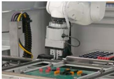
Die Mitarbeiter haben Freiraum für andere, komplexere Aufgaben. Die geschlossene, sicherheitsüberwachte Roboterzelle ermöglicht extrem schnelle Bestückgeschwindigkeiten bei hoher Präzision, was sehr kurze Zykluszeiten zur Folge hat. Die Bauteilzuführung basiert auf marktüblichen Systemen, die Auswahl erfolgt bauteil- und prozessspezifisch.
