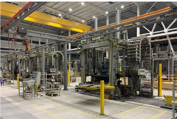
Gießelinie mit Ofenshuttle im Keller für die Produktion von Radträgern, Strukturteilen sowie kompletten Achsträgern hohl gegossen
