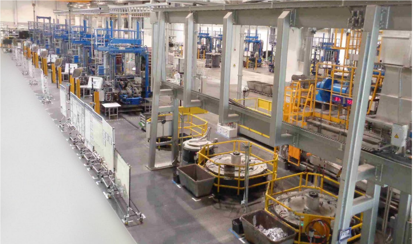
Turnkey-Gießerei für die Produktion von Motorblöcken bei BMW Brilliance Automotive in China
