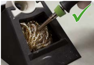
Lötkolbenspitze leicht in die Metallwolle einstecken und drehen
