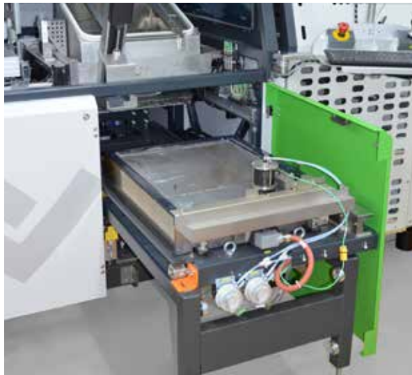
Löttaggregat in Wartungs- und Einrichteposition
