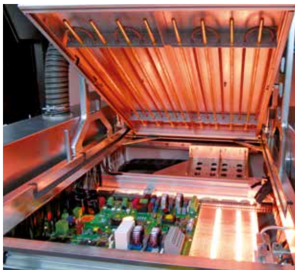
Das Ersä Vorheizkonzept – ein perfektes Zusammenspiel von dynamischer Unter- und Oberheizung mit Venturi-Prinzip für reproduzierbare Ergebnisse
