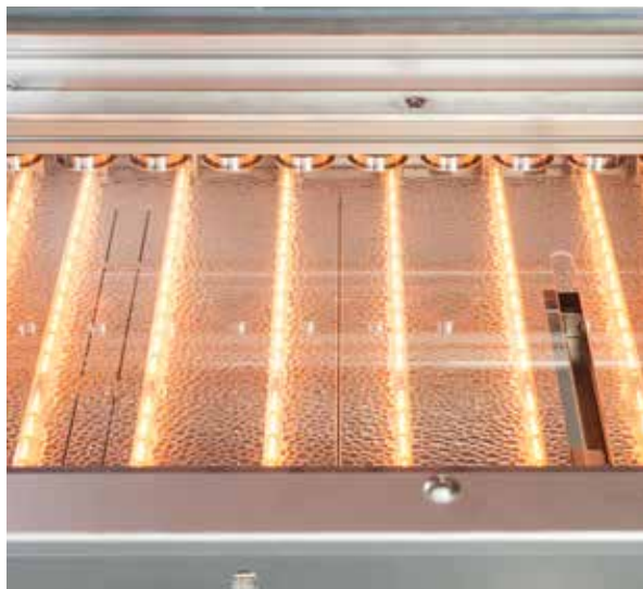
Unterseiten-Vorheizung – Strahler in Gruppen schaltbar
