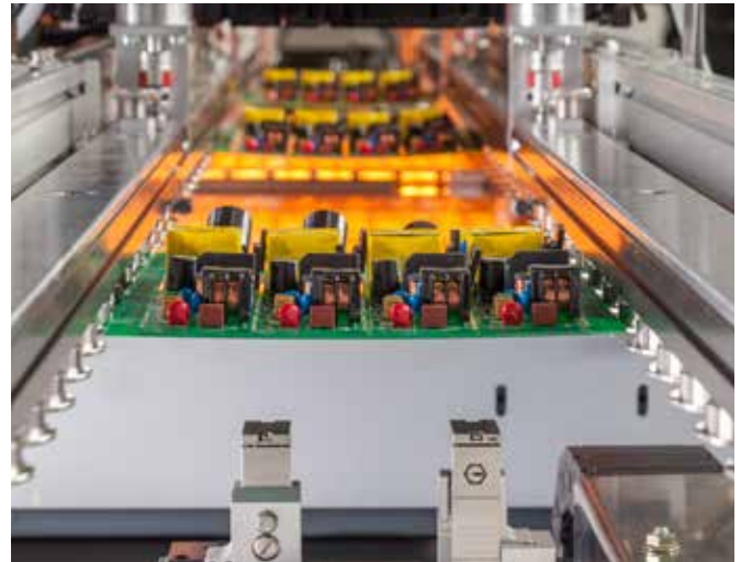
Multidrop-Präzisionsfluxer: höchste Prozesssicherheit durch Flussmittelmengenmessung
