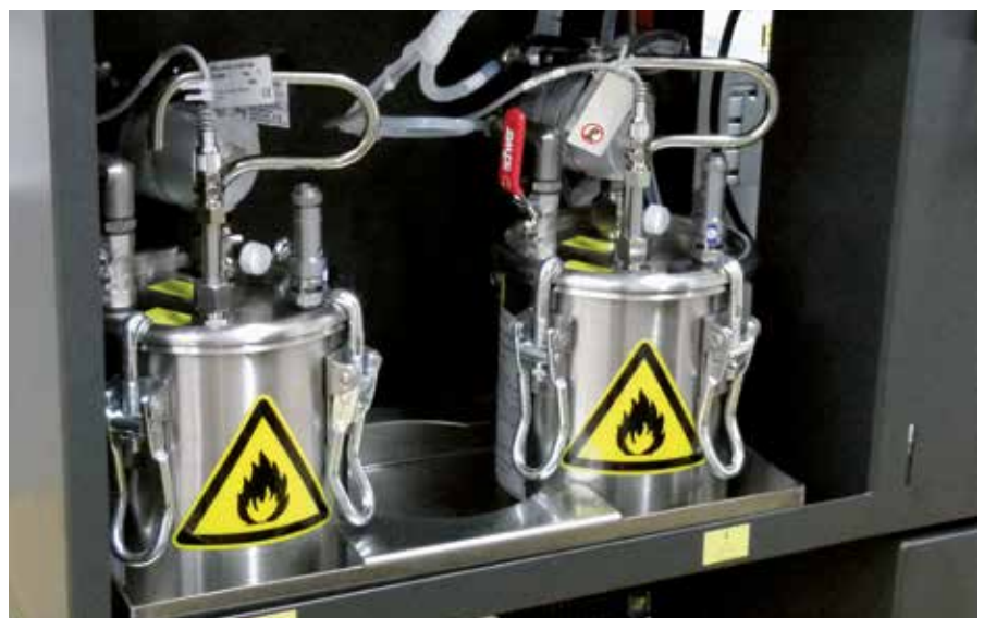
Versorgung mit 2 Flussmittelbehältern
