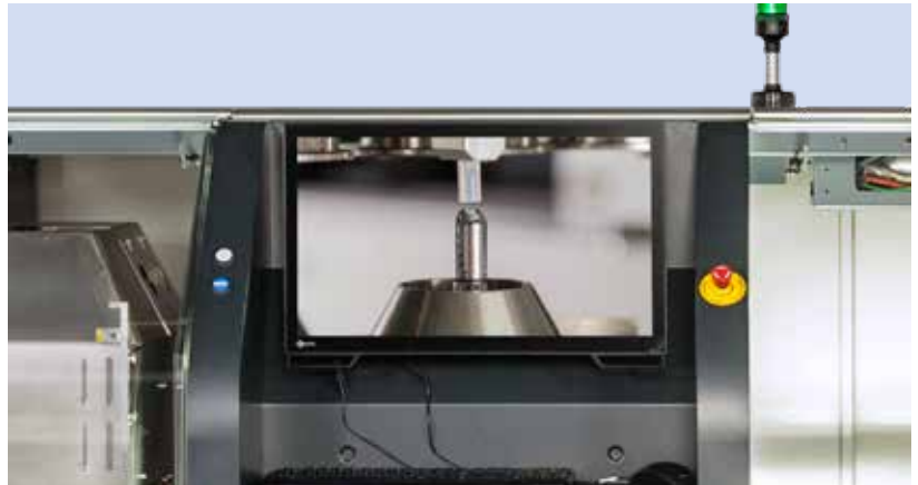
Visuelle Prozesskontrolle – Kamerasystem stellt auf Wunsch die Lötergebnisse dar
