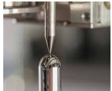
Automatische Überwachung der Lötwellenhöhe
