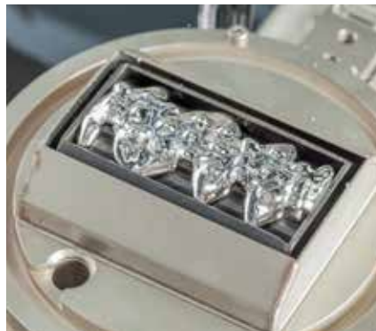
MINI-VARIO-WAVE ■ Lötbreite: 75 mm ■ Wellenlöten bei 0 Grad ■ Einstellbare Verfahrensgeschwindigkeit und Wellendruck
