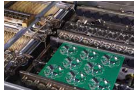
Schmiermittelfreier Rollentransport im Vakuummodul
